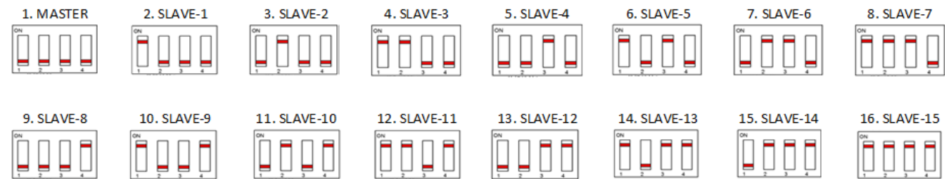
Schemat 5.2 Ustawienia adresów ADS determinujących rolę danego akumulatora w układzie
